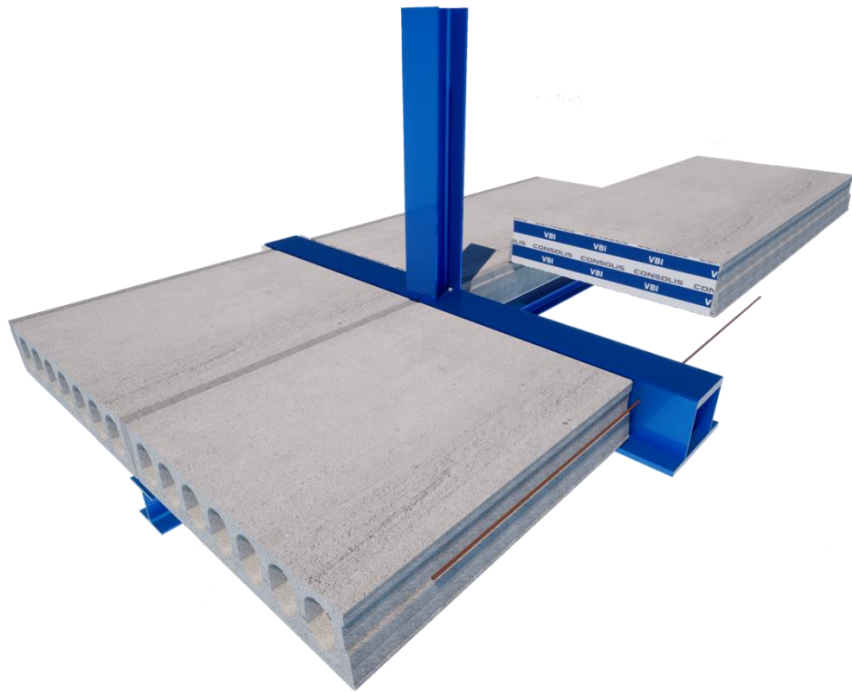
Figuur 16 – Betonnen kanaalplaatvloer (1)
