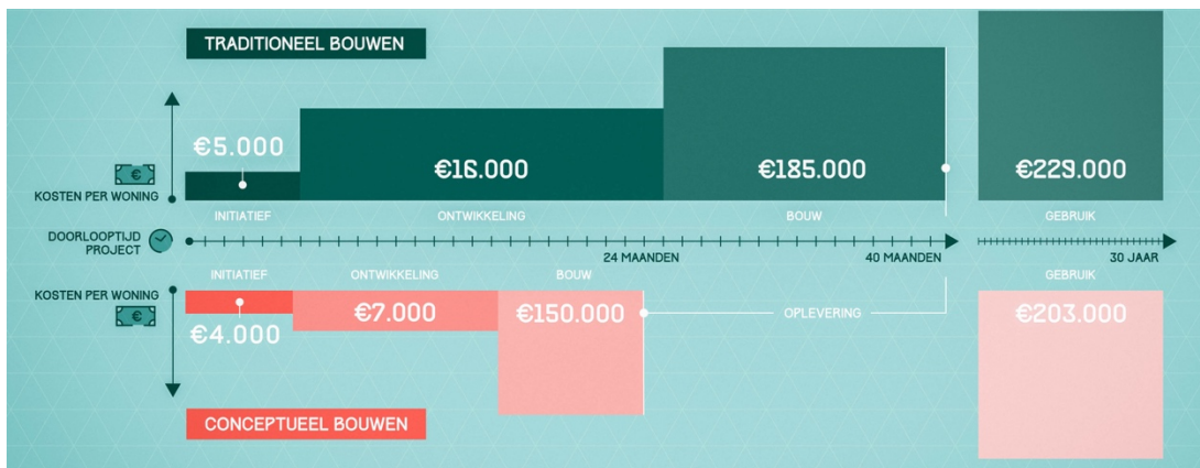
Figuur 3 verschil in kosten per woning tijdens de gebruiksfase (helemaal rechts) voor de bouw van 20 woningen (2 blokken van 10 woningen)
